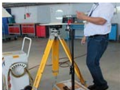
Přenosná referenční stanice ke zpřesnění signálu GPS. Žlutá "trojnožka" s přijímačem se postaví na geodeticky
